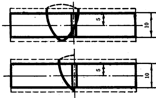
图 4 开在熔合线的缺口位置
